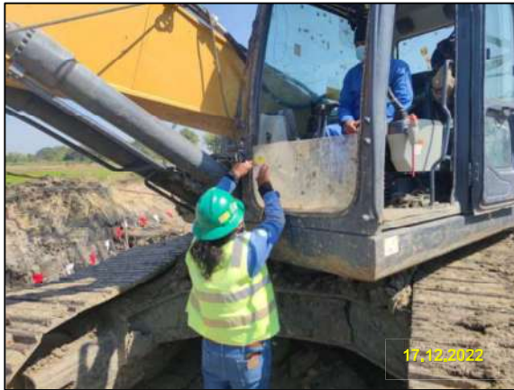
ก) การตรวจสอบรถแบ็คโฮก่อนนำมาใช้งาน
