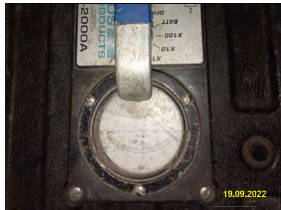
ค) วัดค่าปริมาณรังสีพื้นที่ยานตรวจสอบรอยเชื่อม
