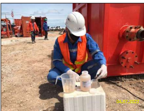
รูปที่ 2-23 การเก็บตัวอย่างน้ำทิ้งจากการทดสอบท่อด้วยวิธีทางชลสถิต (Hydrostatic Test)
